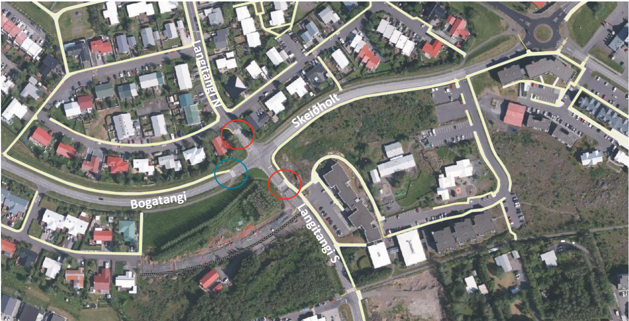
MYND 9 Núverandi stígakerfi við gatnamót Langtanga – Bogatanga, þveranir við gatnamótin merkt með hringjum, upphækkanir með rauðu en í plani með bláu (map.is/moso).
